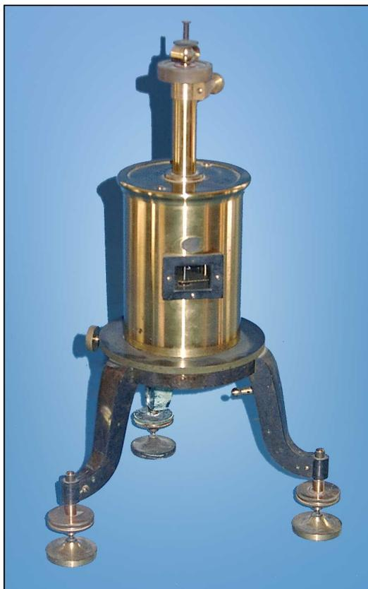
FIGURA 3.5 Eletrômetro de Dolezalek ou de quadrantes. (RUDD, 2005).
